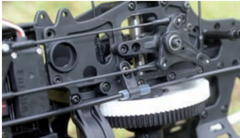
Zusätzliche Arretierung für den Heckrotor-Steuerdraht, um ein Schwingen zu verhindern
