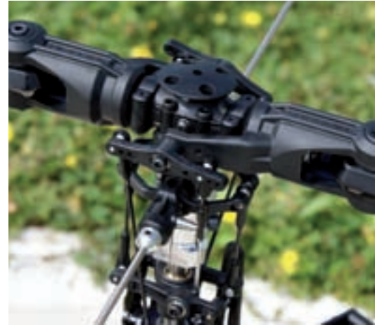
Der Hirobo-Rotorkopf FZ-IV, der in erster Linie für die vortrefflichen Flugeigenschaften des SDX verantwortlich zeichnet
