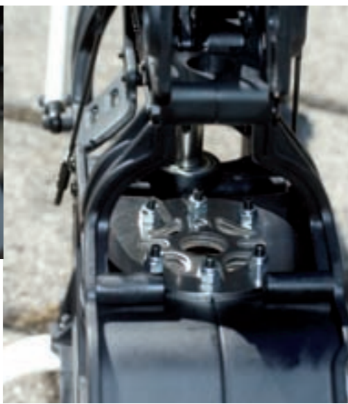
Hier wird deutlich, wie sich die Antriebs- und RC-Komponenten unterbringen lassen. Ganz vorn sitzt schräg angeordnet der zusätzliche 2s LiPo-Empfängerakku, darunter der Empfänger und ganz unten der Controller. Die in den Seitenteilen integrierten Servos sitzen senkrecht und lenken über Umlenkhebel die Taumelscheibe an
