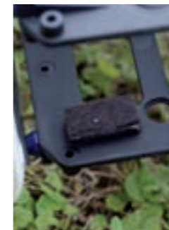
Am Chassis angeklebte Filzgleiter verhindern das Scheuern der LiPo-Akkus
