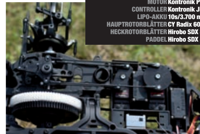
Hier das rechte und vordere Taumelscheibenservo mit ihren Anlenkungen. Deutlich zu erkennen auch das kleine Sensorgehäuse des CY Gyro-Systems
