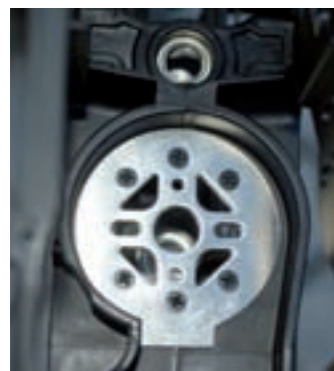
Zentrale Rolle des Elektro-Conversion-Kit ist nicht nur die Chassis-Bodenplatte, sondern auch die ausgeklügelte Motorbefestigung. Sie besteht aus drei miteinander zu verschraubenden Edelstahlplatten, die passgenau im Ansaugbereich des Lüfterschacht montiert werden
