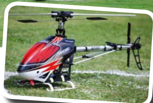
Das Referenzmodell der SDX Challenge, der Hirobo SDX in der Elektro-Spezial-Variante mit Kontronik-Antrieb (Pyro und Jazz) sowie 6s-LiPo-Akku. Hier das Modell des zweitplatzierten Stefan Burndorfer aus Österreich
