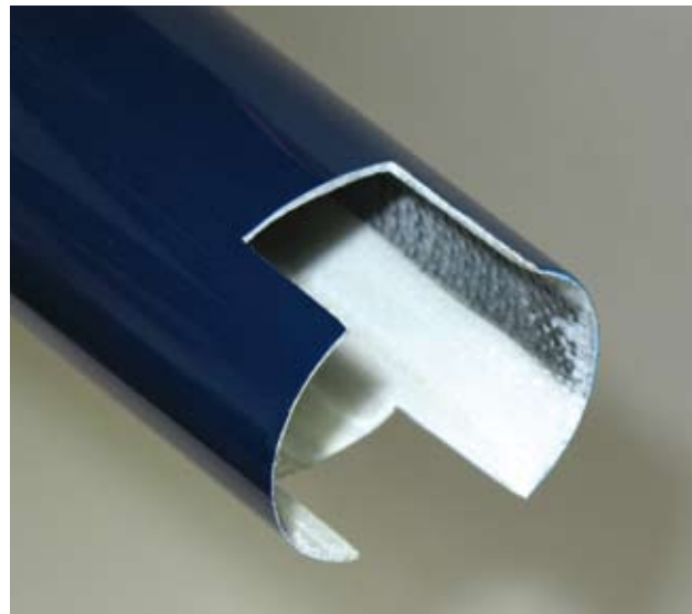
Durch diese Ausschnitte muss die Heckpartie nicht gekürzt werden. Beim Zurückziehen der Mechanik mit montiertem Heckrotor fügt sich dieser hier berührungslos ein
