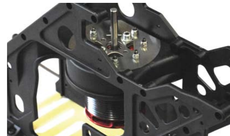
Hier ist der Pyro 30-14 bereits mittig zentriert mit zwei M4-Schrauben eingesetzt
