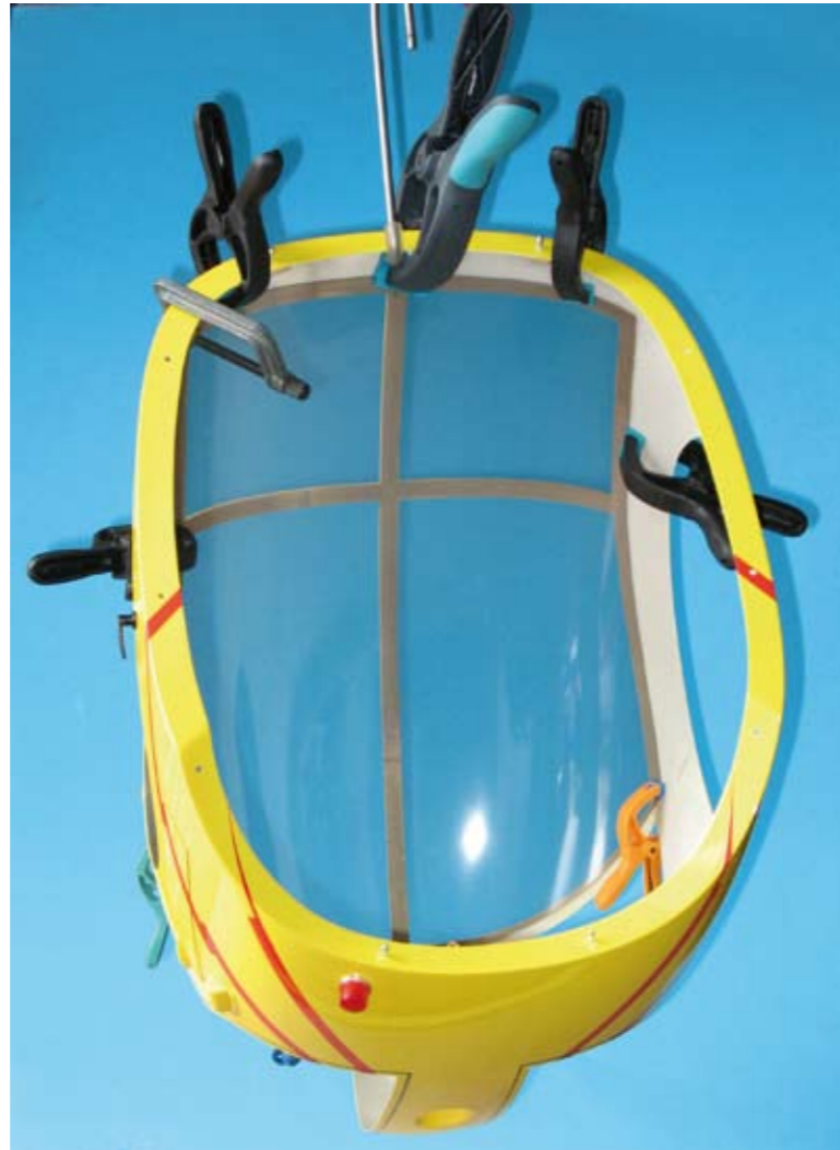
Die große Frontscheibe lässt sich vor dem Verkleben rundherum mit Klammern und Schraubzwingen in korrekter Position befestigen. Durch die mittige Aufhängung wird ein Verziehen vermieden
