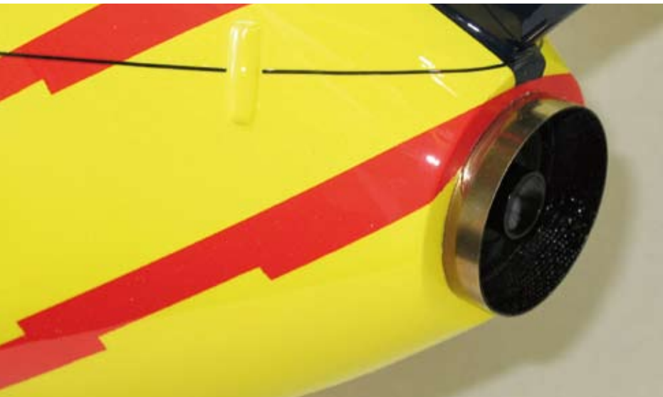
In die formschöne Heckpartie muss noch das kurze Abgasrohr eingeklebt werden
